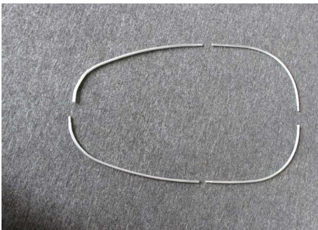
Prenez les quatre éléments de l'hiloire et disposez-les de sorte que les 2 sections les plus longues soient en face l'une de l'autre et les 2 sections les plus courtes également.
