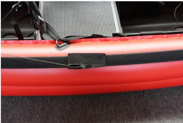
Fixez l'élément de remontée du gouvernail au niveau du siège.
