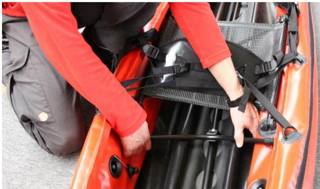
Procédez de la même façon avec l'autre couple derrière le siège.
