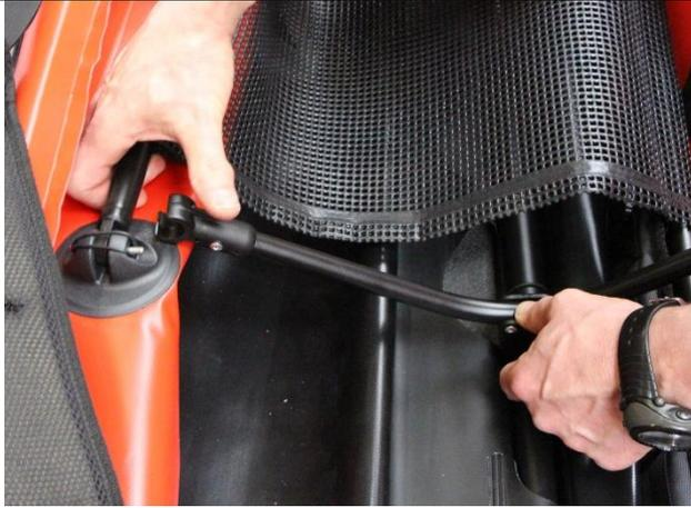
Dès que le couple est redressé à la verticale, clipsez les encoches situées aux extrémités du couple aux barres de fixation du siège.
