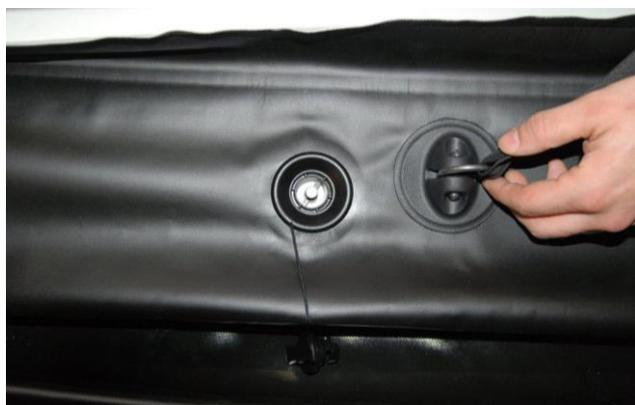
Il faut maintenant gonfler les boudins haute pression latéraux. Vous trouverez **dans le kit de réparation l'adaptateur pour les valves**. Fixez celui-ci au gonfleur manuel. Placez ensuite l'adaptateur dans la valve et faites tourner d'un demi-tour afin de bloquer l'adaptateur dans la valve.
