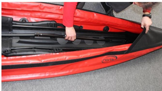
Insérez tout d'abord l'étrave dans l'avant de la toile jusqu'au fond, le "nez" est ainsi bien calé dans la toile du kayak au niveau de la proue.
