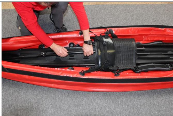
Prenez ensuite le longeron de quille avec le demi-tube riveté et insérez le sous le siège pour aller le clipser avec le longeron installé précédemment.
