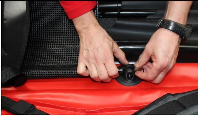
Allez ensuite au niveau du siège. Les deux fixations avant du siège se détachent en retirant la goupille de sécurité.
