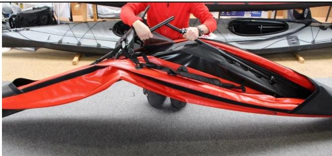
Repoussez ensuite les longerons avec précaution vers le bas jusqu'à ce que ceux-ci se retrouvent l'un sur l'autre sur le plancher du bateau. On obtient une bonne rigidité dans toute la longueur, l'ossature tendant bien la toile.
