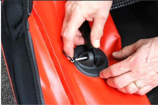
Remplacez ensuite la barre du siège dans sa fixation et sécurisez l'attache à l'aide de la goupille.
