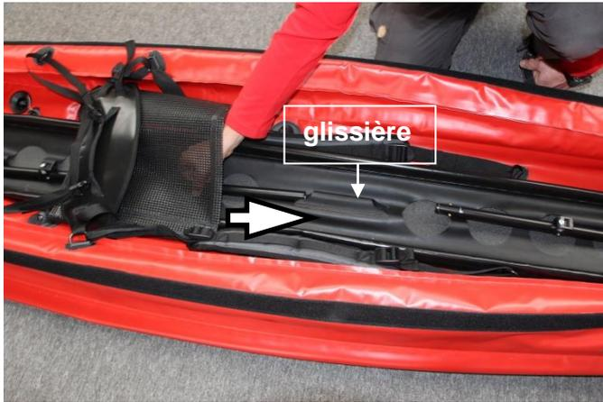
Prenez ensuite le longeron de quille au bout arrondi et insérez le par l'extrémité ouverte sous le siège et dans la glissière en direction de la proue.
