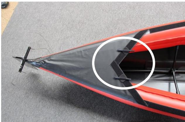
Scratchez les deux traverses de corde de direction à l'arrière sur la bande velcro *comme indiqué sur l'illustration ci-contre.*
