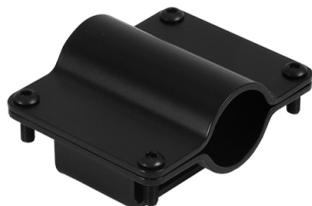
Bride de fixation pour montage sur tube; composée de deux tôles ép. 3mm avec empreinte pour tube, patch antidérapant et visserie de différentes longueurs.
